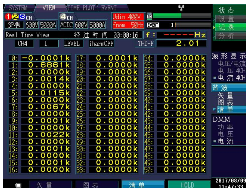
图 3-4 治理后 1#变下无功柜进线 A 相各次谐波电流含量
