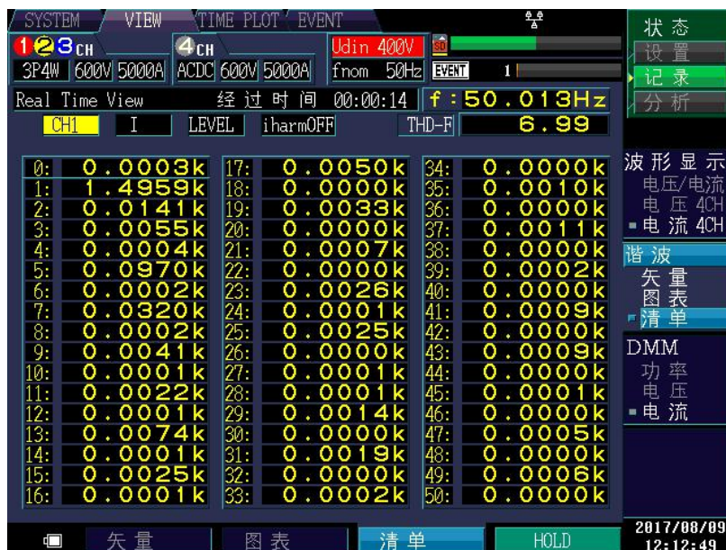
图 3-6 治理后 1#变次总进线柜 A 相各次谐波电流含量
